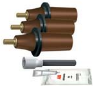
PC 630-3 Переходник для параллельного соединения. Заменяет перемычку в CSE-A при параллельном подсоединении к другому CSE-A на напряжение 12-24 кВ.
